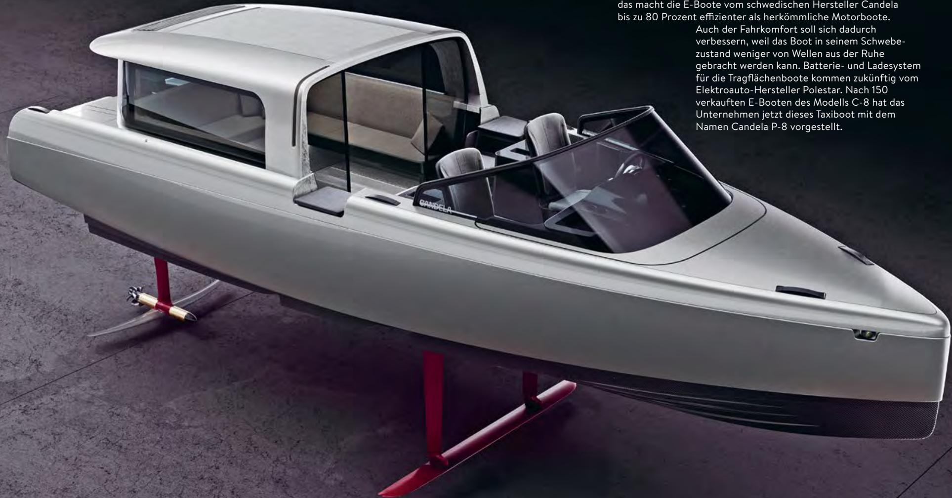
Durch computergesteuerte Tragflächen-Unterwasserflügel wird der Rumpf des E-Boots über die Wasseroberfläche gehoben. Der Widerstand des Wassers wird so erheblich reduziert, und das macht die E-Boote vom schwedischen Hersteller Candela bis zu 80 Prozent effizienter als herkömmliche Motorboote.
